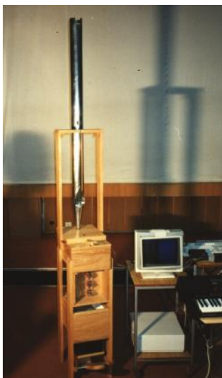
Rys. 3. Model organów piszczałkowych (a), układ sterowania trakturą organową (b)
