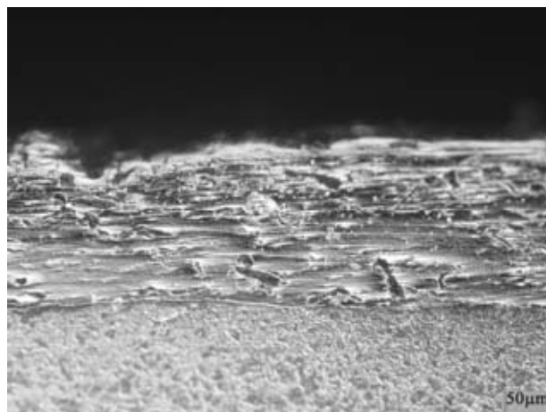
Rys. 1. Mikrostruktura powłoki Ni-5%Al: a) po natryskiwaniu cieplnym, b) po obróbce plastycznej na zimno poprzez prasowanie
