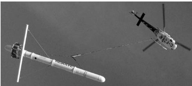
Rys. 6. System magnetometryczny podwieszony na śmigłowcu (www.fugroairborne.com)
