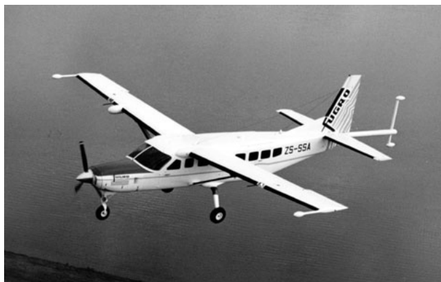
Rys. 3. System magnetometryczny TRIAX na samolocie typu Caravan ( www.fugroairborne.com )
