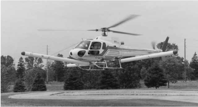
Rys. 5. System magnetometryczny na śmigłowcu z trzema magnetometrami (www.fugroairborne.com)
