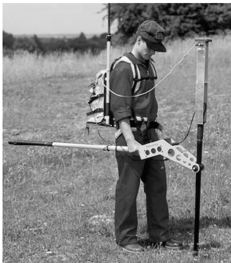
Rys. 11. Transduktorowy system magnetometryczny (www.foerstergroup.de) Fig. 11. Fluxgate magnetometer system (www.foerstergroup.de)
