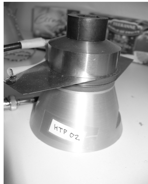
Rys. 3. Transmitter sygnału ultradźwiękowego z czujnikiem piezoelektrycznym
