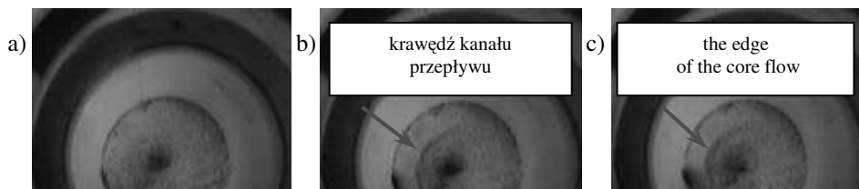
Rys. 6. Kształtowanie się kanału przepływu na wysokości 1,55 m dla pierścienia wewnętrznego 180/100/70 (mm) na wysokości 1,00 m od dna silosu w czasie: a) 6,08 s, b) 6,12 s oraz c) 6,16 s opróżniania silosu (piasek średnio zagęszczony, d_{50} = 1,0 mm, d_o = 0,07 m, ściana gładka) Fig. 6. Flow profile at the height of 1.55 m in the case of application of internal ring 180/100/70 (mm) at the height of 1.0 m above the bottom at the time of: a) 6.08 s, b) 6.12 s and c) 6.16 s of silo emptying (medium dense sand, d_{50} = 1.0 mm, d_o = 0.07 m, smooth wall)
