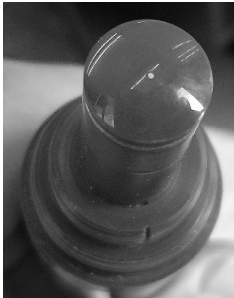
Rys. 1. Elektrody pomiarowe typowego czujnika tlenu według koncepcji Clarka Fig. 1. Measuring electrodes of the typical oxygen sensor in accordance to Clark's conception
