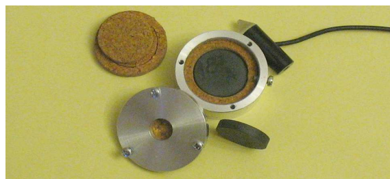
Rys. 6. Głowica mechaniczna z czujnikiem do ultradźwiękowej spektroskopii rezonansowej warystorów
