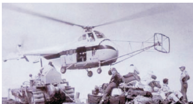
Rys. 7. System elektromagnetyczny zainstalowany na helikopterze
