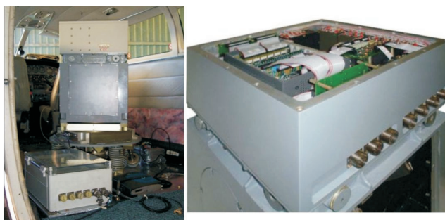
Rys. 13. Grawimetr GT-1A zainstalowany na samolocie Cessna 404 ( www.canadianmicrogravity.com ) fot. za zgodą firmy Canadian Micro Gravity
