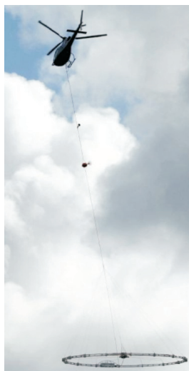
Rys. 11. System HeliGEOTEM firmy Fugro zainstalowany na śmigłowcu
