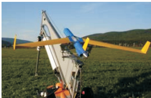
Rys. 5. Pojazd GEORANGER z systemem magnetometrycznym [9]
