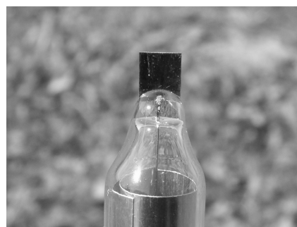
Rys. 2. Srebrna elektroda redoks
