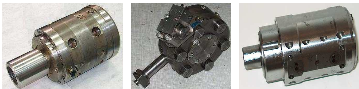
Rys.1. Silniki satelitowe. Od lewej: typ HS, typ HF, typ SM (silnik badany) [3, 4, 6, 7, 8, 9, 10]
