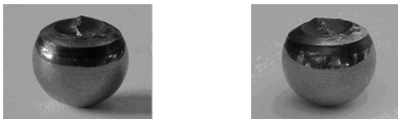
Rys. 10. Charakter pęknięcia kulki górnej obciążonego czterokulowego wężła tarcia tocznego smarowanego emulsją wodno-olejową HFA-E [L. 10, 11]
