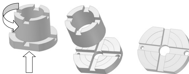
Rys. 2. Postać geometryczna próbek stosowanych w tribometrze PT-3. Od lewej do prawej: próbki w pozycji roboczej (strzałkami zaznaczono kierunek obrotów i siły dociskającej próbki), para próbek po rozsunięciu czół, próbka dolna (nieruchoma) z widocznym położeniem ścieżki tarcia
