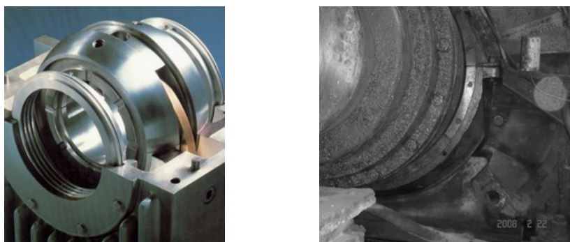
Rys. 3. Typowe łożyska ślizgowe podparte na czaszy kulistej
