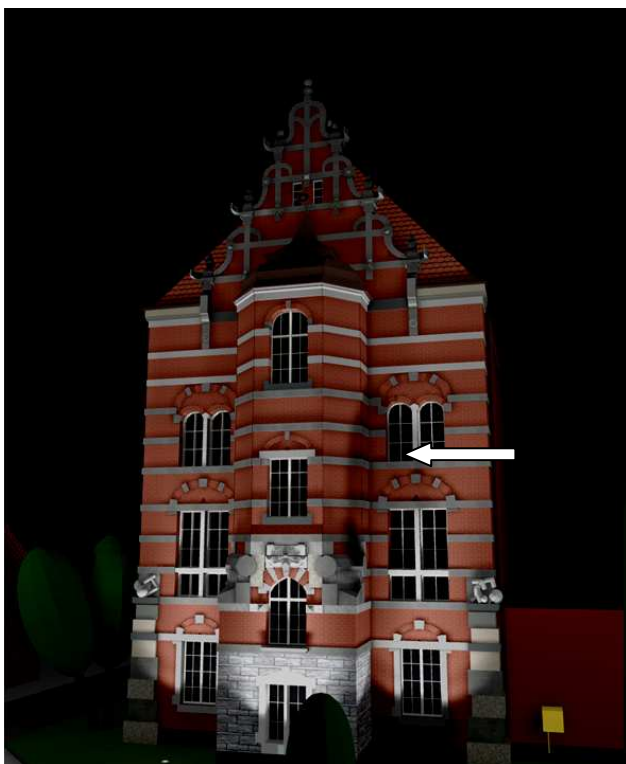
Rys. 9. Wizualizacja iluminacji przy nieprawidłowym usytuowaniu naświetlacza na słupie. Strzałką wskazano cień drzewa
