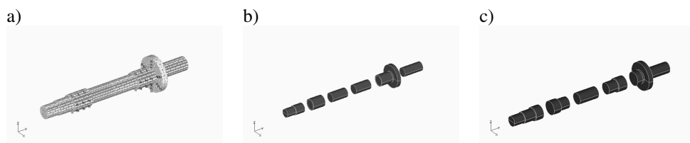
Rys. 2. Modelowanie wrzeciona: a) model 3D ciągły z podziałem na OES, b) podział wrzeciona na części odpowiadające SES, c) podział wrzeciona na części odpowiadające EST
