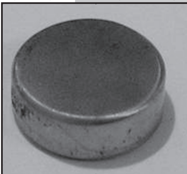
RYS.1 Widok próbki wyciętej z implantu FIG.1 The view of an implant sample
