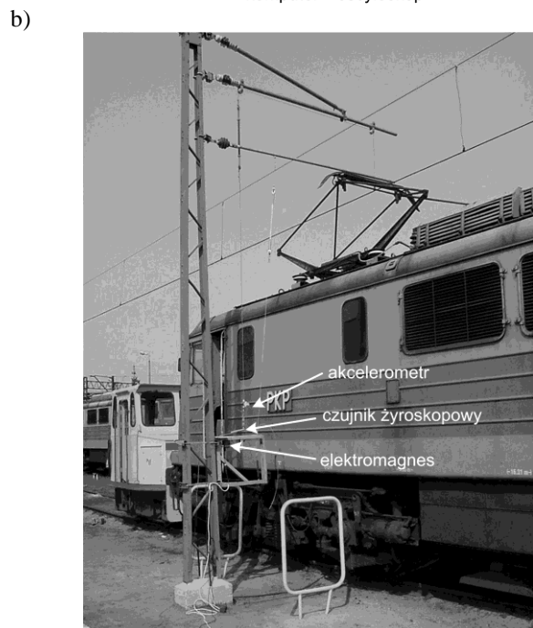
Rys. 12. Eksperymentalne terenowe stanowisko do badania stanu zawieszenia ślizgacza: a) szkic konstrukcyjny, b) widok stanowiska
