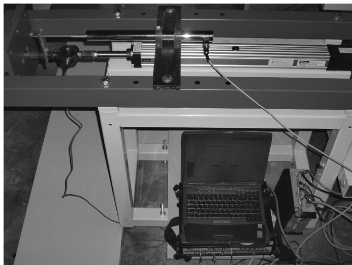
Rys. 1. Stanowisko eksperymentalne do dynamicznego ściskania-rozciągania Fig. 1. Setup of the dynamic push-and-pull experiment
