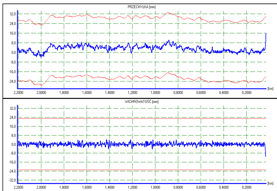
Rys. 3. Wykres przechyłki i wichrowatości toru
