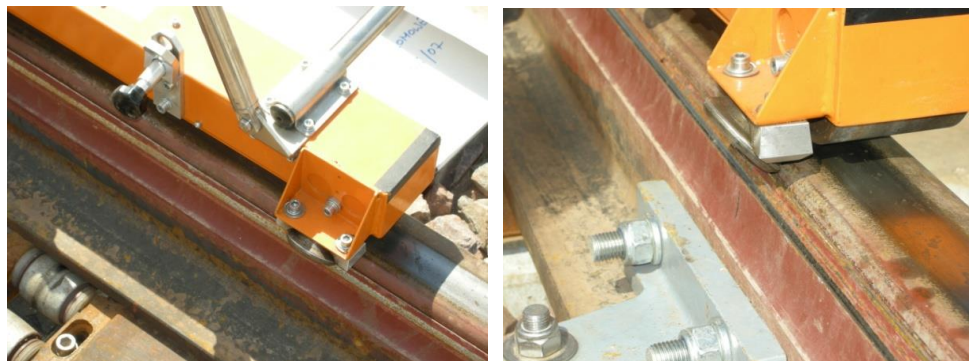
Fot. 7. Przejazd przez zwrotnicę prostą
