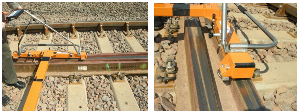
Fot. 8. Przejazd przez krzyżownicę w torze zwrotnym
