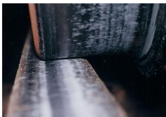
Rys.2. Przykładowe położenie koła w stosunku do szyny
