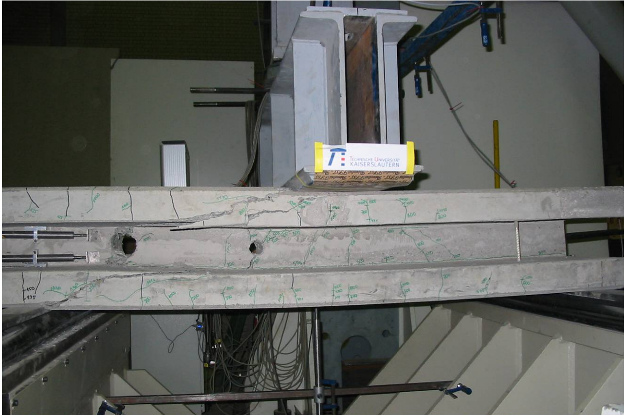
Bild 23: Dritter Versuch mit dem großen Träger nach dem Erreichen der maximalen Kraft
