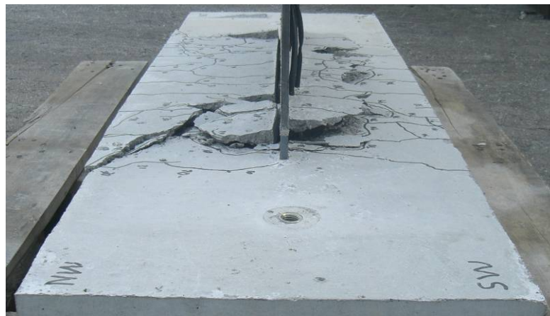
Bild 18: Ausbruchkegel beim Ausziehversuch
