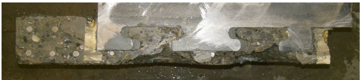
Bild 13: Prüfkörper Nr. 2 nach dem Zerlegen: unverformter Stahlsteg
