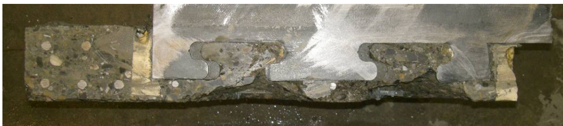
Bild 13: Prüfkörper Nr. 2 nach dem Zerlegen: unverformter Stahlsteg
