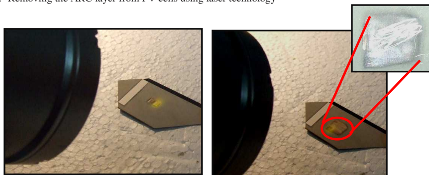
Rys. 4. Usuwanie metalizacji tylnej z ogniwa PV z wykorzystaniem techniki laserowej
