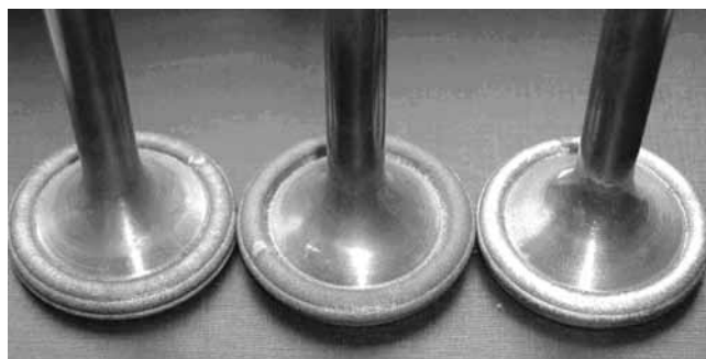
Rys. 2. Zawory po napawaniu laserowym Fig. 2. Valves after laser hard-facing
