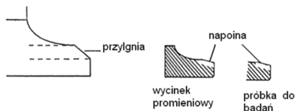
Rys. 4. Przygotowanie próbek do badań mikrostruktury i twardości Fig. 4. Samples preparation for microstructure and hardness testing
