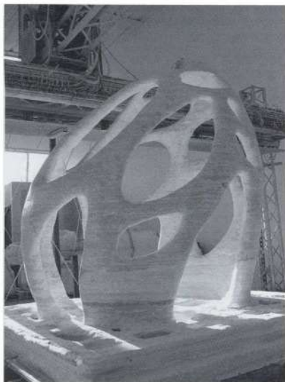
Fot. 2. Radiolaria – dwumetrowej wysokości monolityczny piaskowiec wykonany za pomocą drukarki d_shape (źródło: http://d-shape.com/ )
