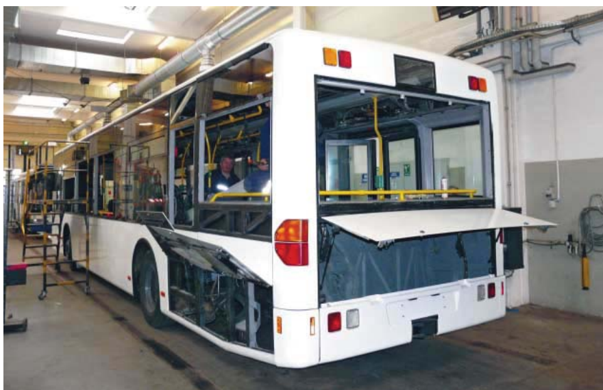
Przystosowywanie tylnej części pierwszego nadwozia Mercedes Benz O530 do zabudowy aparaturą napędu elektrycznego, Gdynia, zajezdnia trolejbusowa na Grabówku, 24.03.2011 r.
