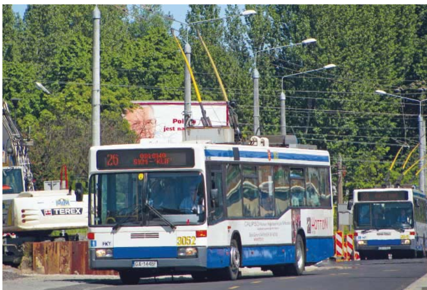
Fot 01 Jedyny egzemplarz trolejbusu MB O405N21 z napędem impulsowym. Na dachu umieszczona przed podstawą odbieraków prądu przetwornica statyczna, nr tab. 3052 (fot. K. Grzonka, Gdynia, al. Zwycięstwa, 04.06.2010 r.)
