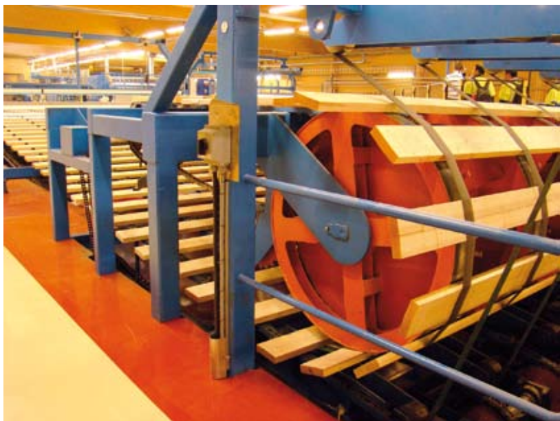
Urządzenie do obracania tarcicy na potrzeby skanera powierzchni.
