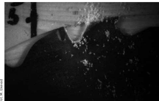
Powstawanie wiórów podczas przecinania sosny suchej i zmrożonej piłą tarczową (po lewej – drewno suche, po prawej – drewno zmrożone).
