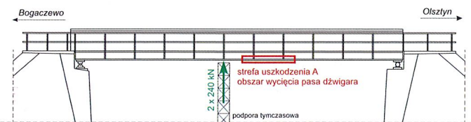
Rys. 12. Schemat wyparcia przęśla podczas naprawy
