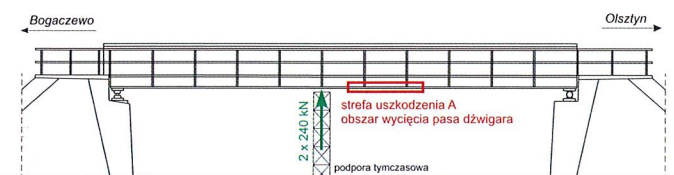
Rys. 12. Schemat wyparcia przęśla podczas naprawy
