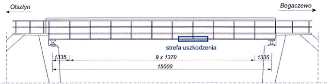
Rys. 6. Schemat przęsła z zaznaczeniem strefy uszkodzenia dźwigara od strony Gdańska
