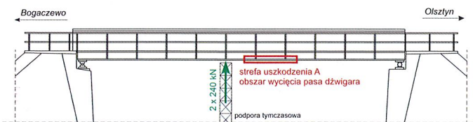
Rys. 12. Schemat wyparcia przęśla podczas naprawy
