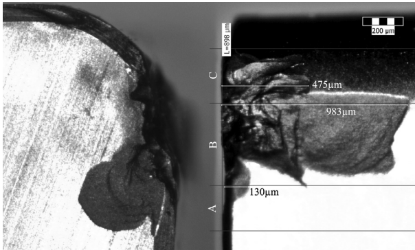
Rys. 3. Widok płytki WNGA080408T01030AWH z naniesionymi wybranymi wartościami zużycia Fig. 3. View of the WNGA080408T01030AWH insert and selected values of the wear
