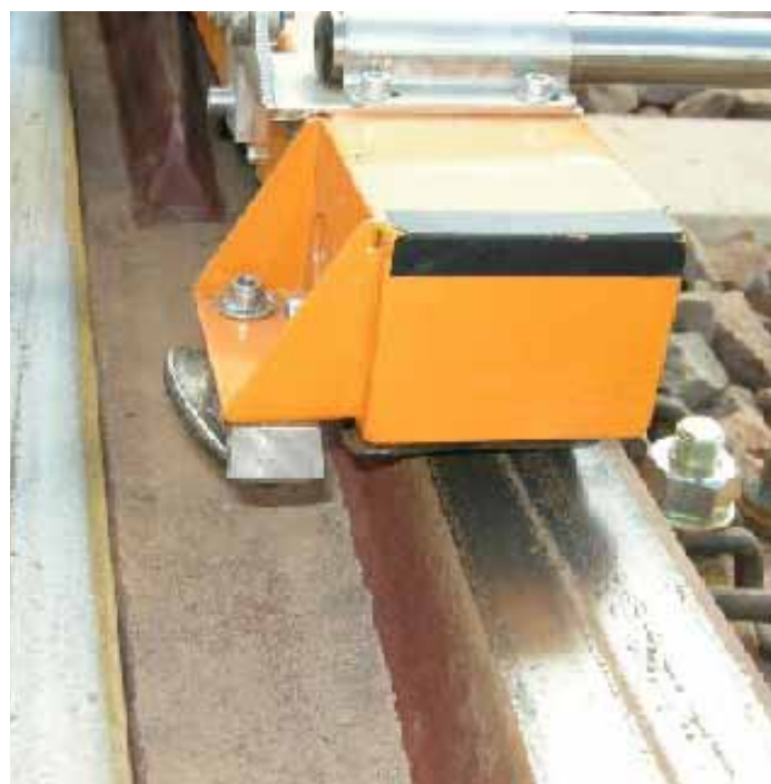
7. Przejazd przez krzyżownicę kierunek na wprost
