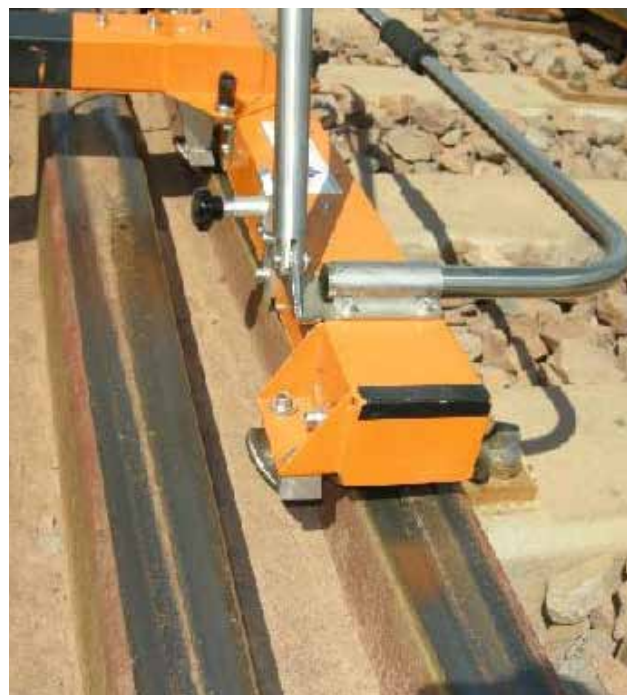
9. Przejazd przez krzyżownicę w torze zwrotnym
