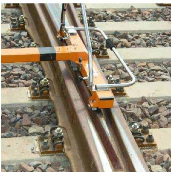
7. Przejazd przez krzyżownicę kierunek na wprost
