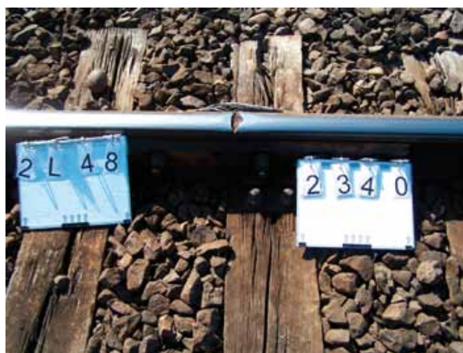
7., 8. Rozwój wady 227 squat (pęknięcie i miejscowe zagłębienie powierzchni tocznej) w torze nr 2 w lewym toku szynowym w km 482,340
