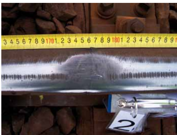
7., 8. Rozwój wady 227 squat (pęknięcie i miejscowe zagłębienie powierzchni tocznej) w torze nr 2 w lewym toku szynowym w km 482,340
