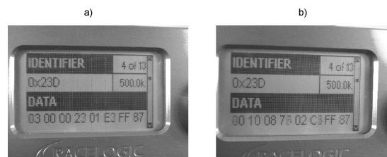
Rys. 7. Wyniki skanowania pokładowej sieci CAN badanego pojazdu: a) 800 obr/min, b) 2000 obr/min
