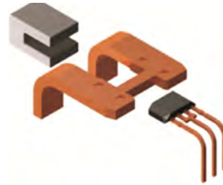
Rys. 9. Struktura wewnętrzna czujnika [2]
