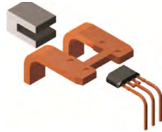
Rys. 9. Struktura wewnętrzna czujnika [2]
