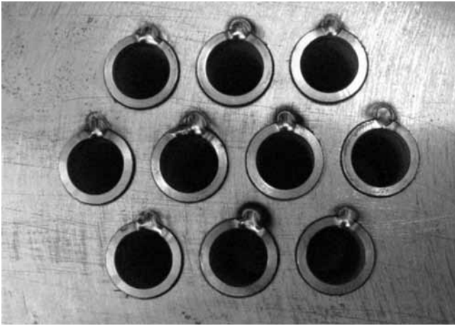
Rys. 8. Złącze próbne z układem trójkątnym rur, przygotowane do kwalifikowania technologii spawania zgodnie z wytycznymi normy PN-EN ISO 15614-8
