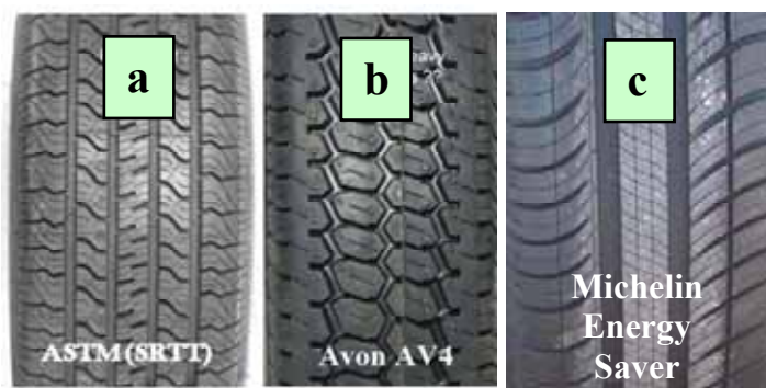
Rys. 4. Bieżniki opon referencyjnych, a – opona SRTT, b – opona Avon AAV4, c – opona Michelin Energy ME
