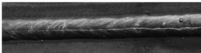
Rys. 10. Złącze doczołowe ze stali S420M wykonane metodą lokalnej komory suchej z pęknięciem zimnym w spoinie
