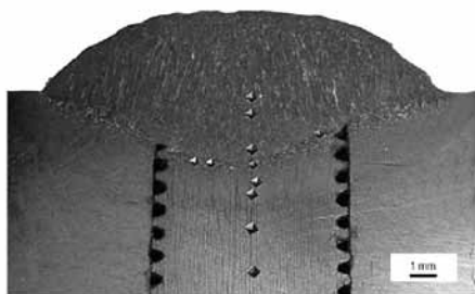
Rys. 15. Zgląd makroskopowy złącza implant po pomiarze twardości [26]
