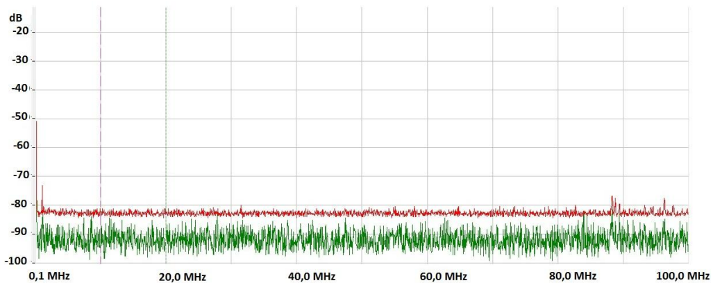
Rys. 4. Zarejestrowana składowa magnetyczna dla pasma 0,1 MHz - 100 MHz przy napięciu wyładowania ESD +1 kV
