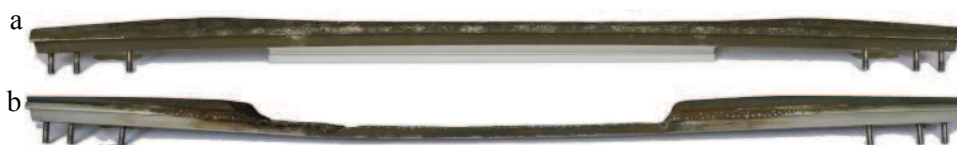
Rys. 1. Widok eksploatawanych nakładek ślizgowych, gdzie: a – nadmierne zużycie, b – całkowite uszkodzenie
