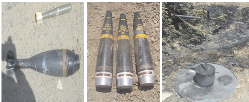
Rys. 1. Urządzenia IED wykonane na bazie uzbrojenia wojskowego (pociski moździerzowe, pociski artyleryjskie, miny)
