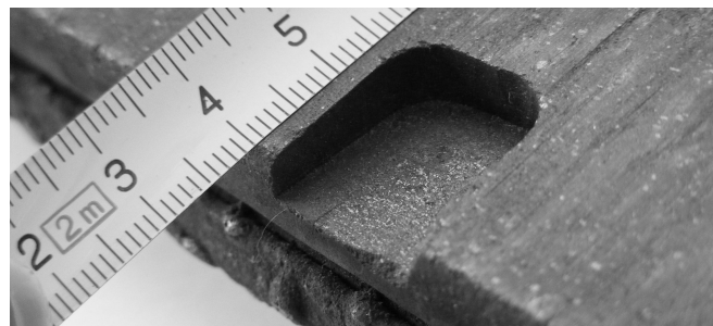
Rys. 9. Fotografia spreparowanego uszkodzenia nakładki stykowej
