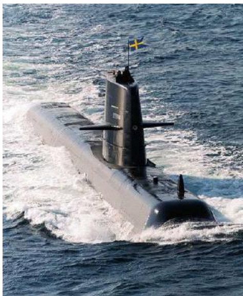
Rys. 3.12. Okręt podwodny HMS Gotland, napęd główny: 2× diesel-electric MTU, napęd pomocniczy: 2xKockums v4-275R Stirling AIP, moc 2x75 kW, prędkość w zanurzeniu 5 węzłów [18]
