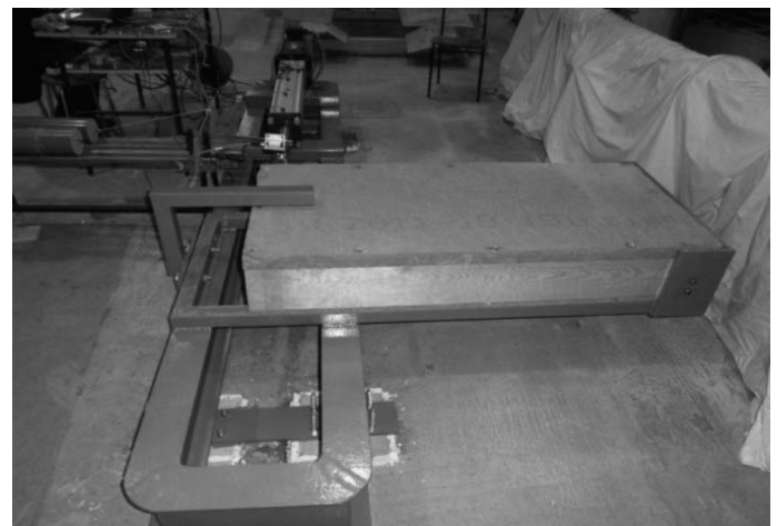
Rys. 1. Widok stanowiska badawczego z zamocowanym elementem ściennym
