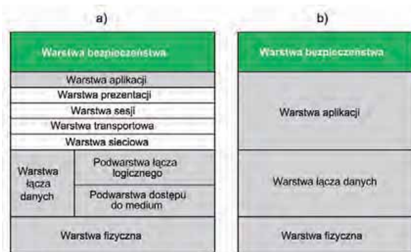
Rys. 2. Model stosu protokołów komunikacyjnych z dodaną warstwą bezpieczeństwa: a) model OSI, b) model uproszczony wg PN-EN 61784-3 [9]
