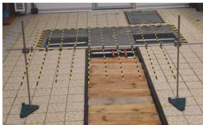
Rys. 1. Widok przyrządu do pomiaru deformacji nadwozia
