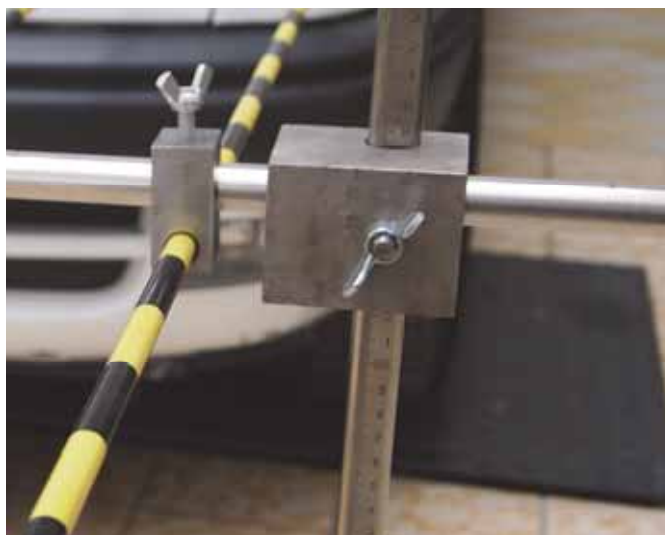
Rys. 3. Połączenie listew poziomej i pionowej
