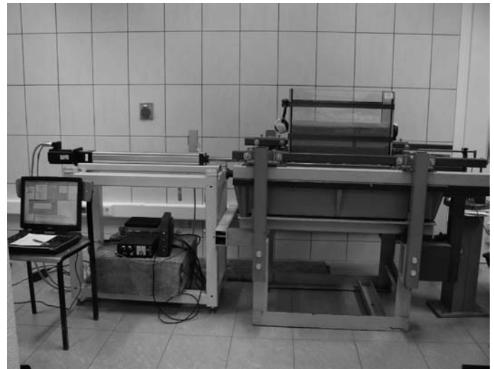
Rys. 1. Stół sejsmiczny, do którego przymocowano akwarium Wewnątrz akwarium usypano warstwę piasku
