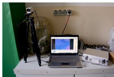
Rys.6. Widok ogólny stanowiska pomiarowego, składającego się z kamery termowizyjnej i przenośnego komputera z oprogramowaniem TIM Connect
