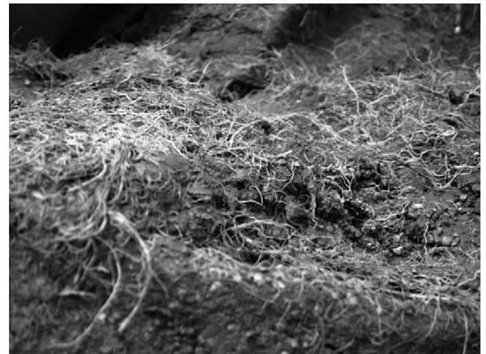
Rys. 11. Kolmatacja geowłókniny pyłem i korzeniami roślin
