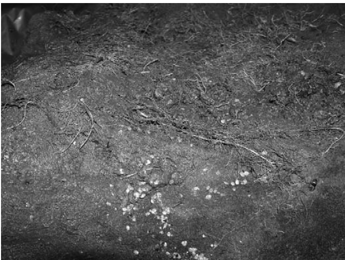
Rys. 11. Kolmatacja geowłókniny pyłem i korzeniami roślin
