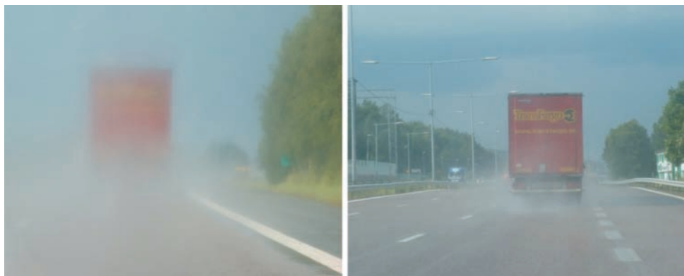
Rys. 6. Wpływ nawierzchni drenażowej na zjawisko rozbryzgiwania wody przez koła pojazdów (zdjęcia wykonane zostały w odstępie kilkunastu sekund, lewe – przed wjazdem, a prawe – po wjeździe pojazdu na odcinek pokryty nawierzchnią drenażową)
